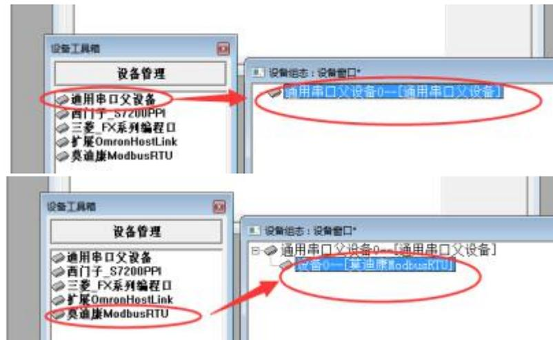
g. 双击编辑 Modbus-RTU 串口参数，设置设备名称，串口设备地址，采集周期，读写功能码等
