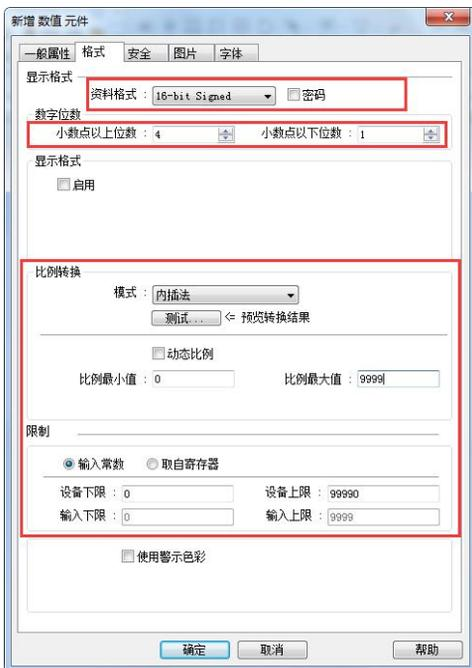
(1)、用于整形数据的倍率转换，例如：0.001 的小数点位置，填写设备上限与比例最大值是：1000:1 的关系，将设备上限设置为 1000，比例最大值设置为 1
