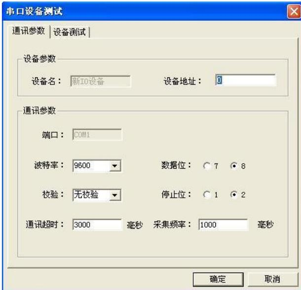
9、进入设备测试页面，进行相应的配置。**这里需要进行重点说明，经过测试发现要读取仪表数据，寄存器号前一定要加上“4”，然后填上需要读取的数据的地址，这里又必须注意的是你要读取的地址加 1 才能正确的读取数据，例如：要读出 A 相电压，A 相电压的地址是 0X4000，对应的十进制是 16384，则你要填上的寄存器第一位是 4，然后是 16384+1，即：416385，数据类型选择为 LONG，设置完成直接按添加即可，如图所示：**
