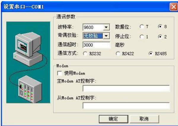
7、在以上配置完成后即可进入串口设备测试页面，点击 COM1，在右边窗口点击“新 IO 设备”，点击右键，择“测试新 IO 设备”，如图所示：
