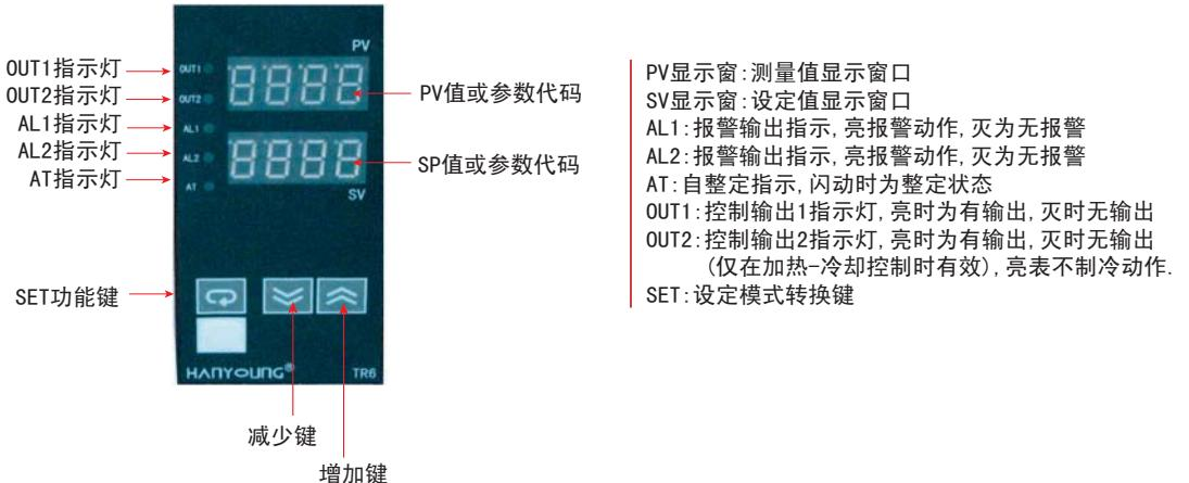
PV显示窗：测量值显示窗口
