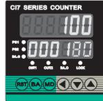
按  $\blacktriangle$  键1次，将数字“7”修改为“8”。按  $\text{MD}$  键确认修改并返回测量状态。
