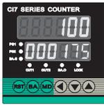
测量状态下按  $\blacktriangleleft$  键进入设定值修改状态。继续按  $\blacktriangleleft$  键，选中数字“5”使之闪烁。
